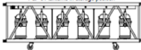
Par 64 lanterns in storage position
